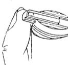
Schieber mit dem Daumen nach oben drücken – Stopfen lässt sich herausheben. Vor dem Verschließen Schieber bis zum Anschlag hineinschieben. Anschließend Stopfen bis zum Einrasten in das Gefäß eindrücken.
